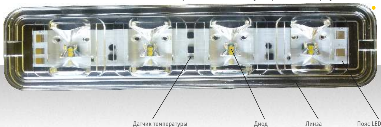
Устройство оптического модуля, применяемого в продукции ROSA LED
