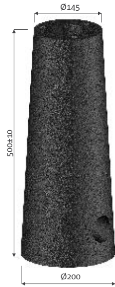
Бетонный фундамент B-0A
