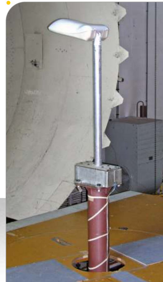
исследование светильника МАГНОЛИЯ в аэродинамическом туннеле
