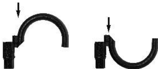
способ монтажа консолей Р в головке
