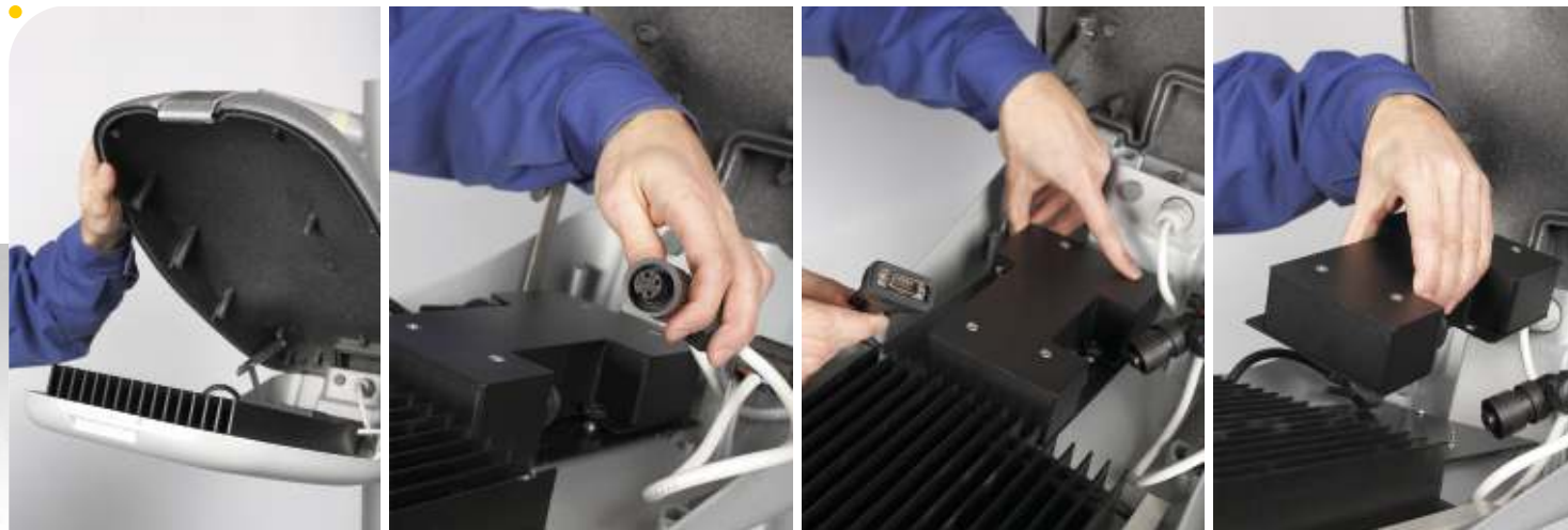
Вывинчивание гаек, крепящих ПРА к светильнику, и отключение питания без применения инструментов
