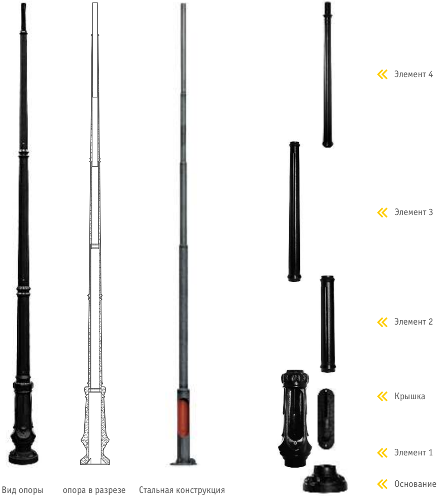
Вид опоры опора в разрезе Стальная конструкция Конструкция опоры типа SM-1W/E
